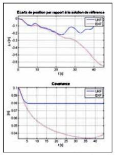
Fig. 6: Haut: Ecarts entre la valeur de référence et la position calculée par filtre de Kalman: comparaison entre EKF et UKF.
