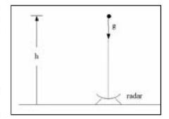
Fig. 5: Chute libre rectiligne d'un corps avec position mesurée par un radar situé sous l'objet.
