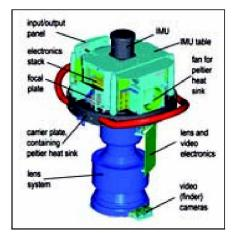
Abb. 6: Sensorkopf Design des neuen SH81/SH82.
