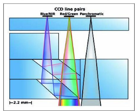
Abb. 7: Design des Tetrachroid-Strahlteilers im Sensorkopf SH81/SH82.
