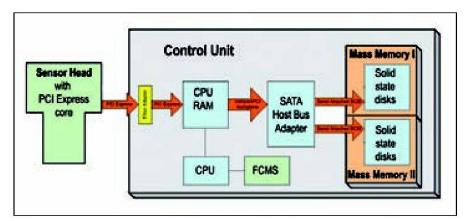
Abb. 4: Leica ADS80 Datenpfad vom Sensorkopf zum Massenspeicher.
