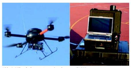
Abb. 1: Mikrodrohnensystem microdrones md4-200.
