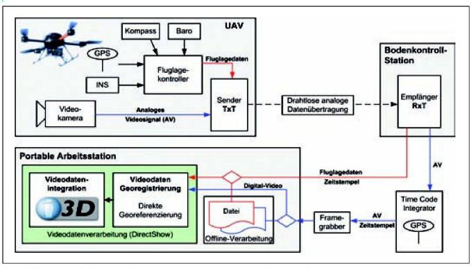
Abb. 5: Systemarchitektur und Videodatenverarbeitungskette der Prototyplösung.
