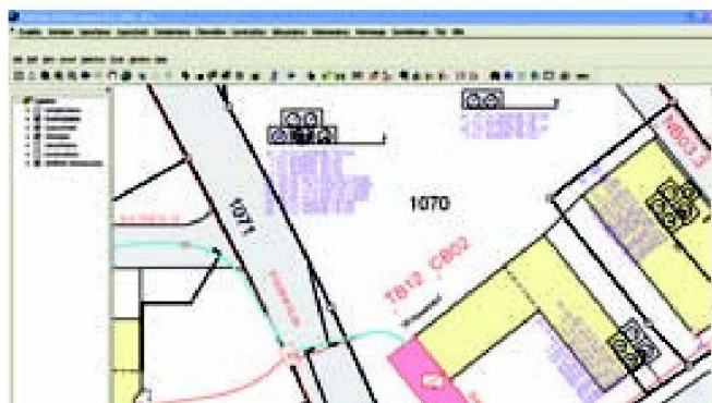
Vergleich der Situation bestehender Daten in ADALIN (oben) und nach der Migration in GEONIS expert (unten).
