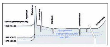
Abb. 4: Einfluss der Rheinsohle auf den Grundwasserspiegel am Beispiel von Ruggell im Fürstentum Liechtenstein (Rheinkilometer 58.4, schematische und überhöhte Darstellung).
