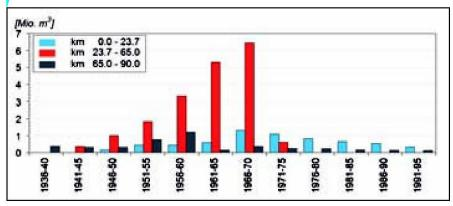
Abb. 3: Geschiebeentnahmen im Alpenrhein in verschiedenen Teilstrecken seit 1936.
