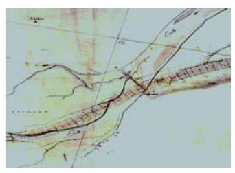
Abb. 4: Alter Linthlauf und projektierter Kanal bei Mollis. Plan von H. J. Frey, 1807.
