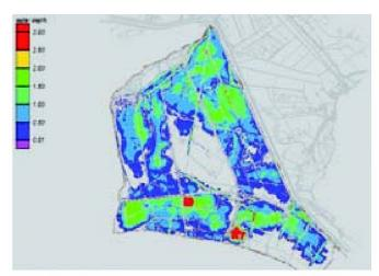
Abb. 5: Die Überflutungsmodellierung zeigt deutlich, dass im Falle eines Dammbruchs grosse Teile der Linthebene überflutet würden.
