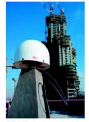
GNSS-Monitoring am Burj Dubai (Turm von Dubai).
