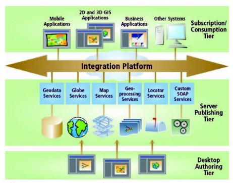
Abb. 4: Eine service-orientierte Infrastruktur mit ArcGIS 9.2.
