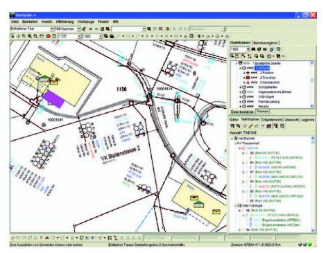
Abb. 3: Benutzeroberfläche der NIS Stromfachschale mit Smallworld 4.
