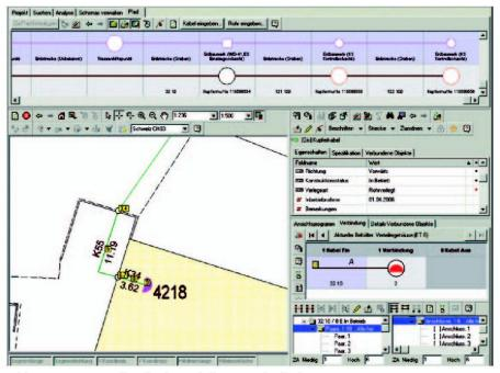
Abb. 2: Benutzeroberfläche Telekom-Fachschale PNI.
