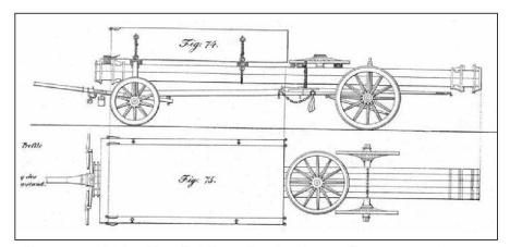
Abb. 6: Material für die «alleinige Militärbrücke»: Balkenwagen mit Ponton-Mittelstück (Birago 1839, Fig. 74 und 75).
