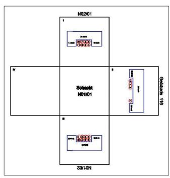
Autom. generierter Kabelschacht.
