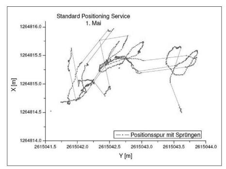
Abb. 2: Sensorpositionen mit dem Standard Positioning Service (Galland, 2007).
