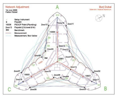
Abb. 5: Netzplan für das Fixpunktnetz.
