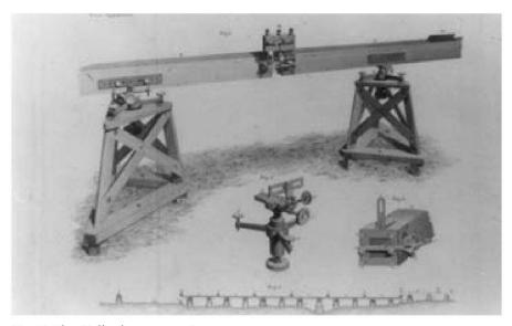
Fig. 3: The Colby bar apparatus.
