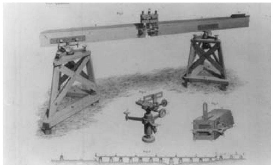
Fig. 3: The Colby bar apparatus.
