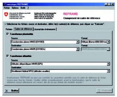
Fig. 4a: Interface utilisateur du nouveau logiciel de transformation REFRAME permettant de calculer, outre la transformation MN03  $\rightleftarrows$  MN95, l'ondulation du géoïde (CHGeo98 et 2004) et l'écart entre NF02  $\rightleftarrows$  RAN95 (HTrans: distorsions des altitudes usuelles NF02/différents systèmes altimétriques). Le logiciel permet aussi de transformer les coordonnées nationales suisses dans des systèmes de référence globaux tels que ETRS89 et WGS84.
