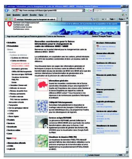
Fig. 6a: Page d'accueil du portail Internet consacré au changement de cadre de référence avec les quatre domaines thématiques suivants: informations générales, section de téléchargement CHENyx06 et DLL, services de transformation en ligne / REFRAME, visualiseur de données FINELTRA.
