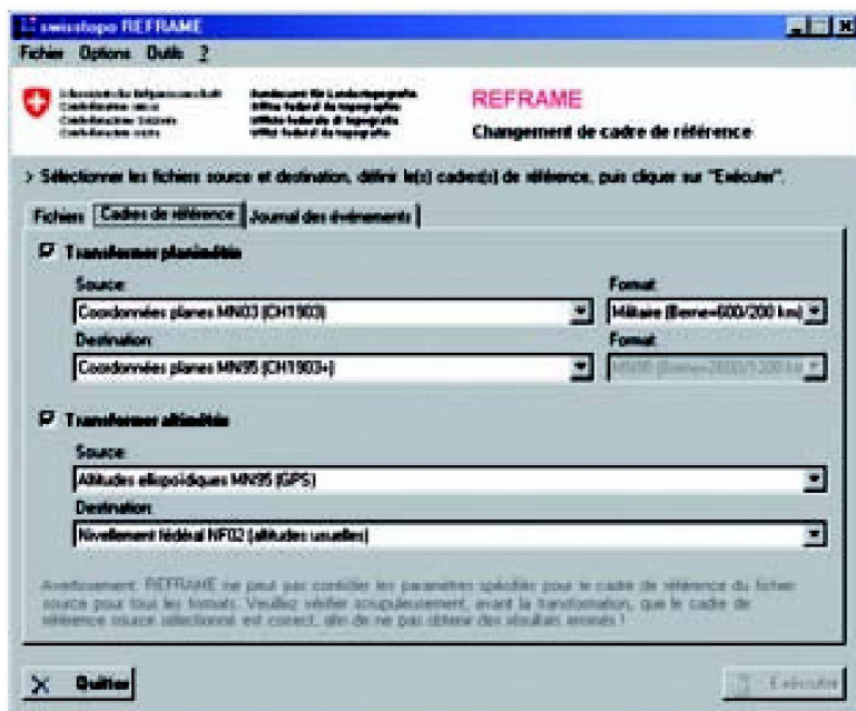
Fig. 4a: Interface utilisateur du nouveau logiciel de transformation REFRAME permettant de calculer, outre la transformation MN03 \rightleftharpoons MN95, l'ondulation du géoïde (CHGeo98 et 2004) et l'écart entre NF02 \rightleftharpoons RAN95 (HTRANS: distorsions des altitudes usuelles NF02 / différents systèmes altimétriques). Le logiciel permet aussi de transformer les coordonnées nationales suisses dans des systèmes de référence globaux tels que ETRS89 et WGS84.
