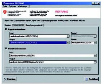
Abb. 4a: Benutzeroberfläche der neuen Transformationssoftware REFRAME, mit welcher neben der Transformation LV03
