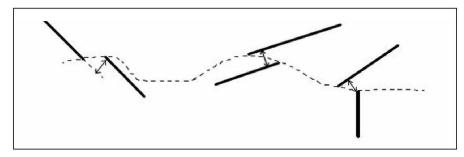
Fig. 4: Mesure de la distance entre deux lignes.
