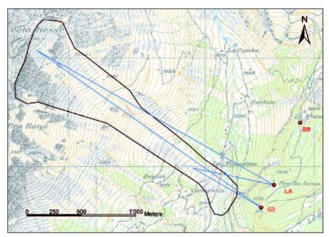
Abb. 1: Die möglichen Kamera-Standpunkte G3, LA und BR (rot) mit den Visuren ins Anriss- und Ablagerungsgebiet (blau) und dem Gefahrenbereich der Lawine (schwarz). Reproduziert mit Bewilligung von swisstopo (BA071266).
