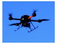
Abb. 5: Drohne md4-200 des Instituts Vermessung und Geoinformation der FHNW.
