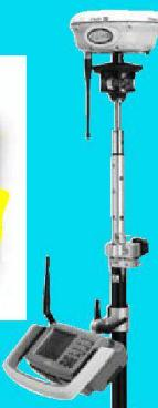
Der neue Trimble IS Rover kombiniert GPS und Tachymeter in idealer Weise zu einem Gesamtsystem. Die Kombination auf dem Prismen/GPS-Stab ist eine einzigartige, von Trimble patentierte Lösung. Nur so positionieren UND orientieren Sie Ihren Tachymeter in EINEM Arbeitsgang.
