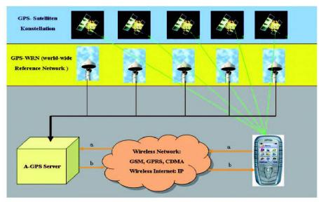
Abb. 2: Ablaufschema der Assisted Data für MS-Based Mode.
