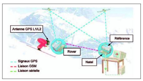
Fig. 1: Application GPS-RTK/GSM pour la trajectographie.
