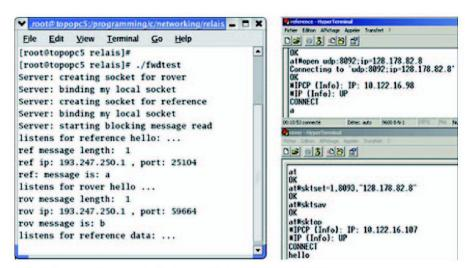
Fig. 3: Apprentissage de l'adresse IP des modules GPRS.
