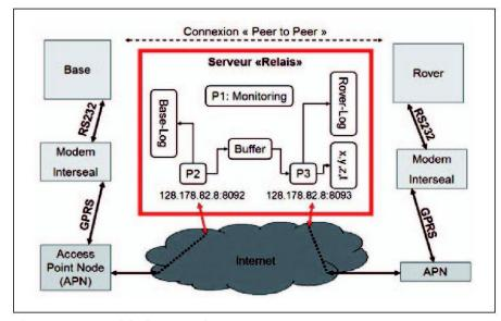
Fig. 2: Serveur relais de corrections GPS.
