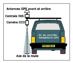
Fig. 2: Le système Photobus avec ses composants principaux (localisation GPS/INS et images CCD).
