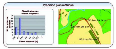
Fig. 3: Analyse de la précision planimétrique de l'axe de route Orbe-Moudon.
