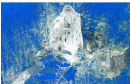
Abb. 2: 3D-Punktwolke der Ruine Homburg (BL), zusammengesetzt aus verschiedenen Laserscans (Ergebnis aus 3D-Blockkurs des 6. FH-Studiensemesters).
