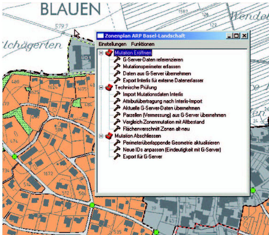
Abb. 2: Benutzerführung im «Mutationstool». G-Server bezeichnet das Geodatabase des Kantons BL.
