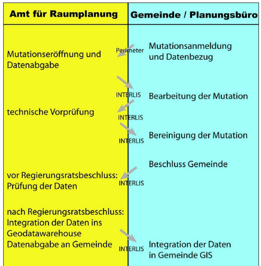
Abb. 1: Ablauf und Datenfluss für eine Zonenplanmutation.
