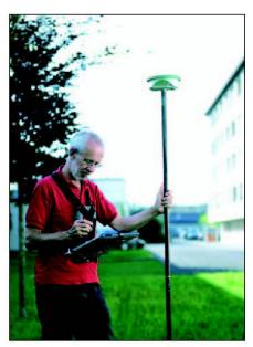
Abb. 1: MobileMatriX mit kabelloser Bluetooth-Verbindung zum GPS-Ro-
