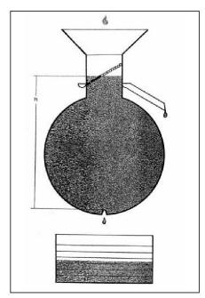
Abb. 2: Prinzip der kalibrierbaren Durchlauf-Wasseruhr.
