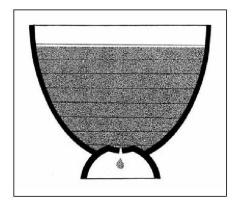
Abb. 3: Prinzip der Auslauf-Wasseruhr.
