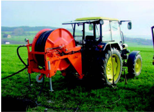
Abb. 5: Modernes Spülgerät für die Hochdruckreinigung von Rohren mit kleinen Kalibern.
