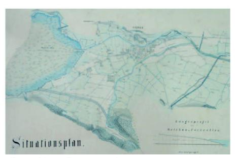
Abb. 3: Melchaa- und Sarneraa-Korrektion in Sarnen. Situationsplan 1:5000 (Ausschnitt; Bau- und Raumentwicklungsdepartement Obwalden).
