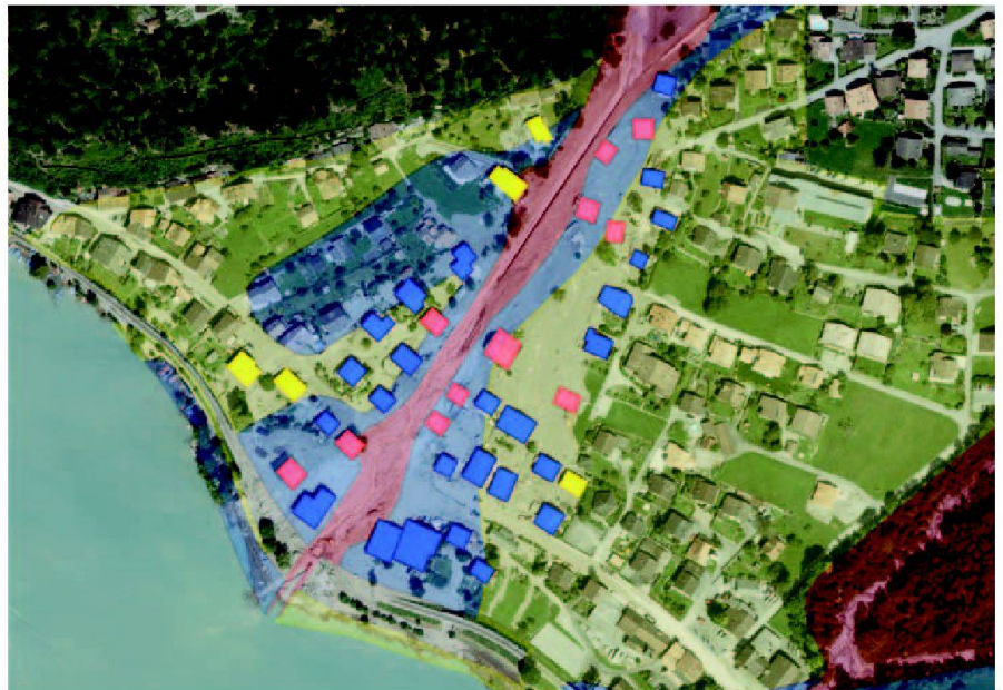
Abb. 6: Orthofoto Mündungsbereich des Glyssibaches in Brienz; Überlagerung Gefahrenkarte und Beschädigungsgrad von Gebäuden.
