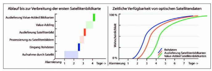
Abb. 3: Abschätzung der Verfügbarkeit von optischen Satellitendaten und des Zeitaufwandes für die Prozessierung der Kartenprodukte.
