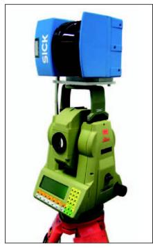
Abb. 5: «Sensor Fusion» von Tachymetrie und terrestrischem Laserscanning. Tachymeter Leica TCA1800 und SICK LMS200 Laserscanner.
