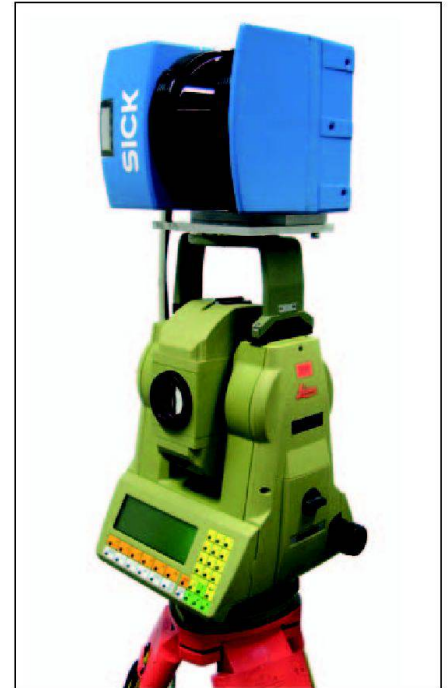
Abb. 5: «Sensor Fusion» von Tachymetrie und terrestrischem Laserscanning. Tachymeter Leica TCA1800 und SICK LMS200 Laserscanner.
