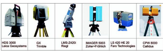
Abb. 1: Auswahl von auf dem Markt erhältlichen terrestrischen Laserscannern.
