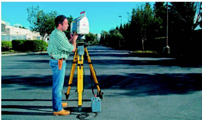
Die Leica ScanStation vereint vier wesentliche Eigenschaften einer Totalstation in einem Laserscanner.
