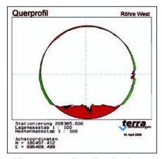
Abb. 4: Aus Punktwolke abgeleitetes Querprofil.
