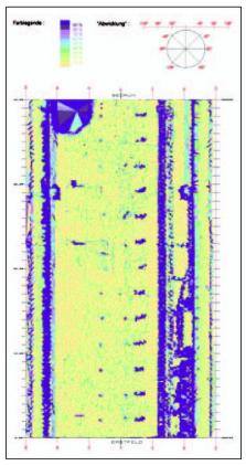
Abb. 5: «Geklappte» Tunneloberfläche mit Neigungen.
