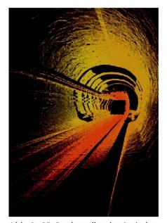
Abb. 2: 3D-Punktwolke der Spritzbetonoberfläche.
