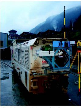
Abb. 1: Scan-Ausrüstung auf Stollenlok montiert.
