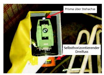
Abb. 2: Tachymeter auf Schreitwerk.
