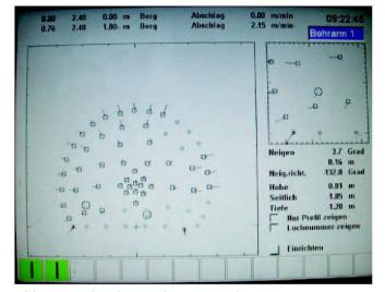
Abb. 1: Display der Ortsbrust im Bohrwagen.
