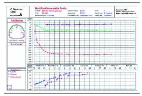
Abb. 8: Beispiel Zeit/Setzungsdiagramm.
