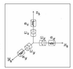
Abb. 1: Prinzip eines inertialen Sensors (Grafik: Karl Foppe).
