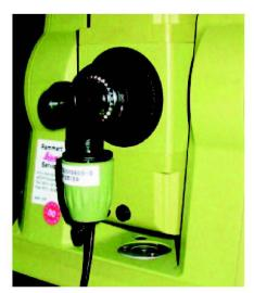
Abb. 2: Autokollimationsokular von Leica.
