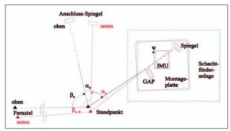
Abb. 4: Schematischer Ablauf der Messungen.
