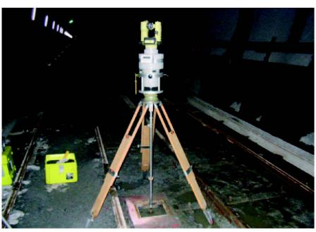
Abb. 3: Präzisionsvermessungskreisel Gyromat 2000 im Einsatz in Bodio.
