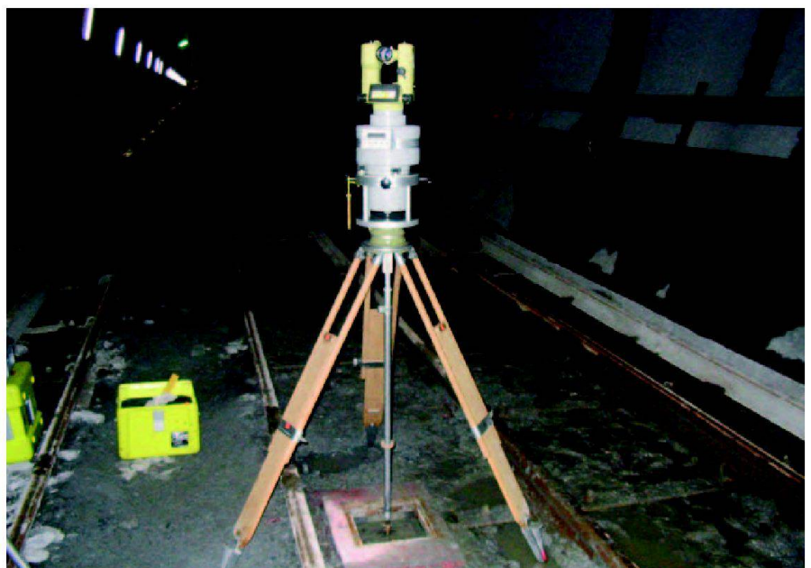
Abb. 3: Präzisionsvermessungskreisell Gyromat 2000 im Einsatz in Bodio.
