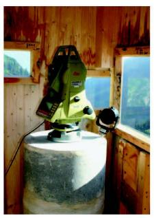
Abb. 3: Tachymeter auf doppelwandigem Pfeiler in Schutzhaus.
