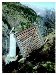
Abb. 6: Beobachtungspunkt mit Meteo-Sensor und Schutzvorrichtung gegen Kriechschnee.
