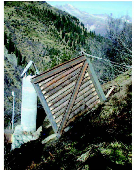
Abb. 6: Beobachtungspunkt mit Meteo-Sensor und Schutzvorrichtung gegen Kriechschnee.
