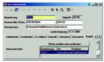
Beispiel eines Spezialbauwerks mit Subtyp-abhängigen und gelinkten Abwasserbauwerk-Attributen.
