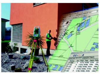
Einmannstation mit MobileMatriX via Funk am Reflektor.
