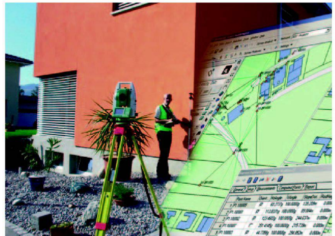
Einmannstation mit MobileMatriX via Funk am Reflektor.
