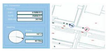
Auf der linken Seite ist der GPS-Connector abgebildet. Er zeigt die aktuelle Position. Im Bereich «Bearing» wird angegeben, wie weit man in welche Richtung gehen muss. In der Benutzeroberfläche der TOPOBASE Webapplikation wählt der Anwender zuerst ein Ziel (z.B. ein abzusteckender Punkt, hier: roter Kreis) und im Anschluss wird in der Karte automatisch die aktuelle Position geladen (blauer Kreis). Die aktuelle Position wird in einem vorgegebenen Intervall immer wieder neu gezeichnet.
