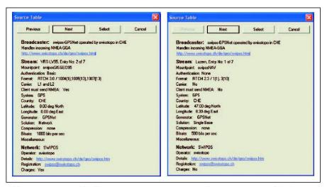
Abb. 3: Source-Table für Datenströme VRS-LV95 (swipos-GIS/GEO) links und Luzern (swipos-NAV) rechts.
