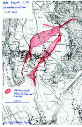
Abb. 2: Die unmittelbar nach dem Unwetter erhobene Schadensausdehnung.
