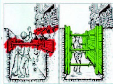
Bei Spriessungen muss darauf geachtet werden, dass sie massiv sind und keine Lücken aufweisen.
