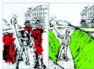
Maximale Böschungsneigungen ohne Spriessung:
