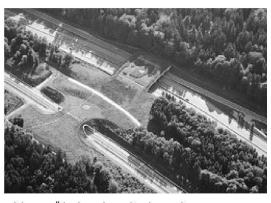
Abb. 1: Ökobrücken lindern die negativen Effekte der Zerschneidung der Landschaft durch Verkehrsbauten, hier A1 und Bahn 2000.
