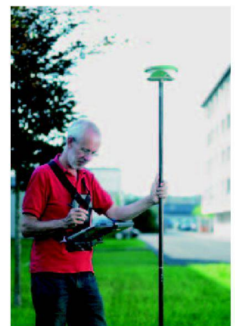
MobileMatriX SmartRover. Kabellose Verbindung von der SmartAntenna direkt zum TabletPC.
