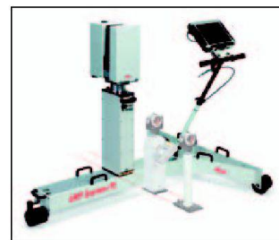
Abb. 2: Das modulare Konzept des Leica GRP System FX ermöglicht es, das Leica GRP5000 als Basis für Systemerweiterungen zu nutzen.
