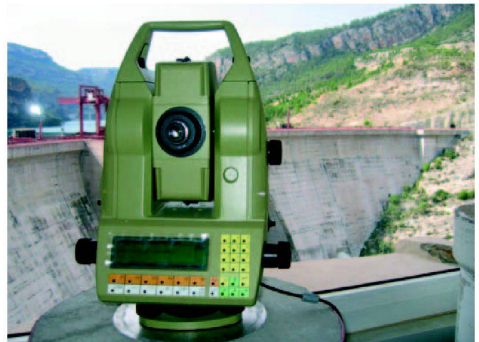
Abb. 1: GeoMoS-Installation am Staudamm, automatische Deformationsmessung.
