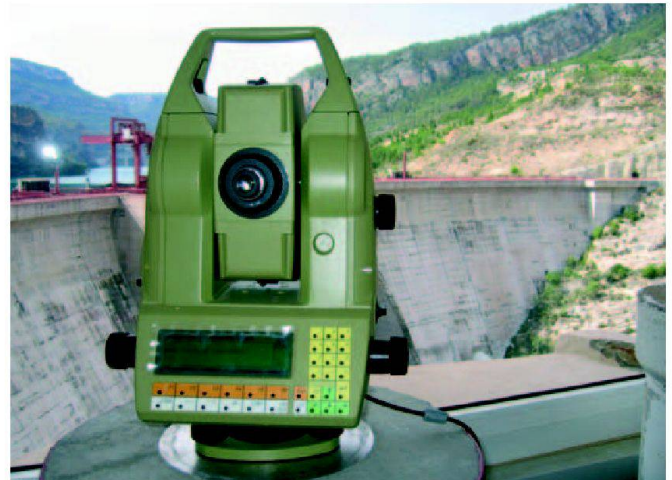
Abb. 1: GeoMoS-Installation am Staudamm, automatische Deformationsmessung.
