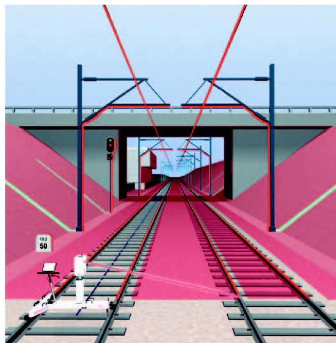
Abb. 3: Mit Leica GRP5000 wird das Gleisumfeld automatisch erfasst.
