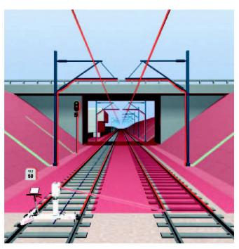
Abb. 3: Mit Leica GRP5000 wird das Gleisumfeld automatisch erfasst
