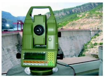
Abb. 1: GeoMoS-Installation am Staudamm, automatische Deformationsmessung.
