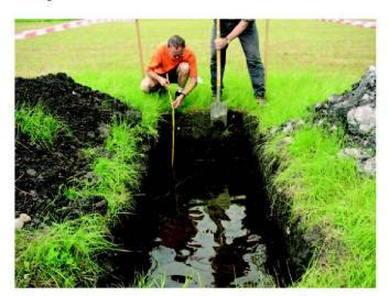
Abb. 2: Bodenprofil als Grundlage der Bodenkartierung.
