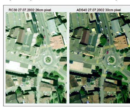
Abb. 4: Vergleich einer simultanen Bildaufnahme mit der ADS40 und der RC30.
