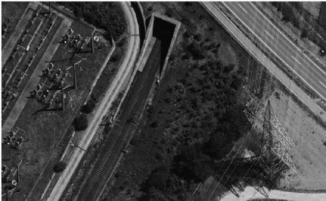
Abb. 2: Vaihingen/Enz, panchromatisch, 5 cm GSD, Flughöhe über Grund 500 m.
