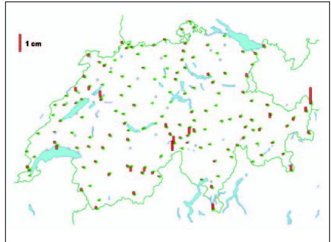
Abb. 4: GPS/Nivellement-Residuen bei CHGeo2004.
