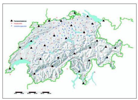
Abb. 1: Das LV95-Netz bestehend aus 106 Hauptpunkten, 102 Verdichtungspunkten und 29 AGNES-Stationen.
