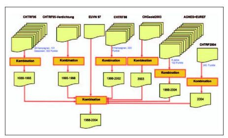
Abb. 3: Kombinationsschema der Gesamtausgleichung basierend auf den Normalgleichungen der GPS-Kampagnen seit 1988 und der AGNES Permanentnetz-Auswertung.
